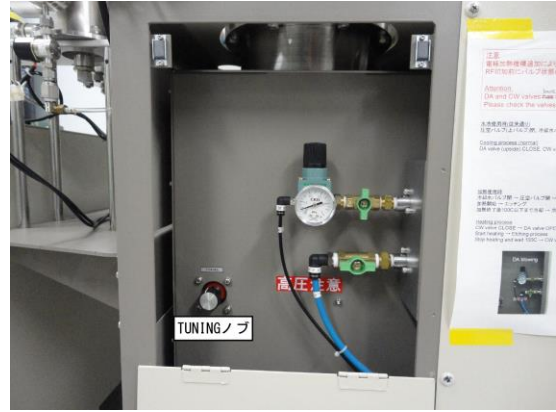
図6 パネル内の TUNING ノブ
